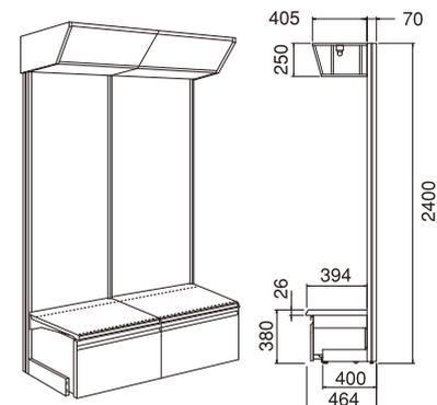
(注、壁面固定金具を利用し、壁面に柱を必ず固定して下さい。)
